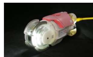
水中ロボット（東芝） 2017年 3号機の原子炉格納容器内の底部水中調査。
