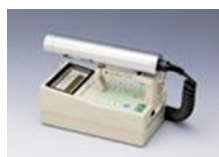
NaIシンチレーション サーベイメータ GM型サーベイメータ
