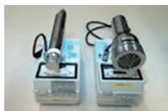
NaIシンチレーション サーベイメータ GM型サーベイメータ
