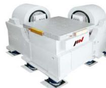
ロボットにランダムに振動をかけ耐振破損性能を試験
