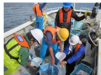
②海水の採取後、均一化した後、原子力規制庁の容器とIAEAの容器に分別
