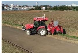
農機の完全無人自動走行のための遠隔監視型システム開発
