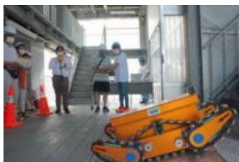
会津大学製 災害対応ロボット
