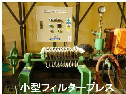
凝集沈殿処理により濁水を浄化、沈殿物をプレスして減容化。
