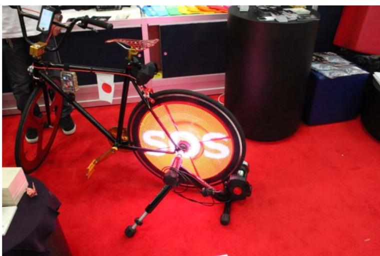
自転車のペダルをこぐと後輪のスポーク部に付いた十字型の LED 基盤が点灯し、回転する光の残像で広告メッセージが表示される。
