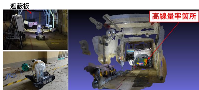
図1. 左:コンプトンカメラをクローラーロボットに搭載し、1F1 号機原子炉建屋内部にてホットスポット探索を遠隔にて実施。右:写真立体復元技術で再構築した建屋内部の3次元モデル上に、ホットスポット(赤色)イメージを投影(補足資料[2]参照)。
